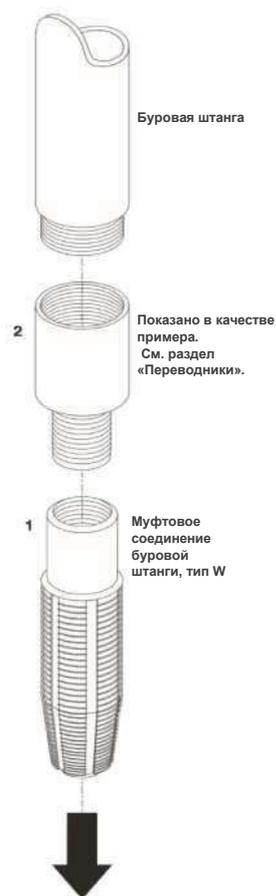
К прихваченной или разрушенной буровой штанге (штангам).
