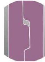
БУРОВЫЕ ШТАНГИ RO С РЕЗЬБОЙ, ИМЕЮЩЕЙ ОБРАТНЫЙ УГОЛ НАКЛОНА ПРОФИЛЯ
