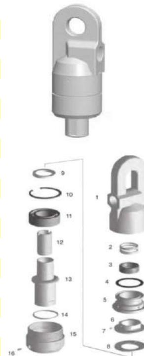
**КОМПЛЕКТ ЗАПАСНЫХ ЧАСТЕЙ ДЛЯ ПРОМЫВОЧНОГО ВЕРТЛЮГА «40К ДЛЯ ТЯЖЕЛЫХ УСЛОВИЙ ЭКСПЛУАТАЦИИ»**
