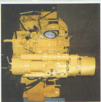
Предназначен для бурения вертикальных и наклонных геологоразведочных скважин вращательным способом.
